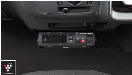
コントローラー（中温冷凍バン、クールバン）*1 荷室内の温度を運転席からチェック。積荷に合わせて最適な荷室内温度を設定できます。 （注）中央席足元スペースが狭くなります。
