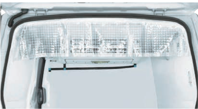
[NO5] 保冷カーテンリヤ（クォータータイプ）*1 荷室内の冷気を逃げにくくします。 （日本トレクス製中温冷凍バンは標準装備） Photo：中温冷凍バン
