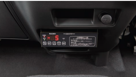
コントローラー（中温冷凍バン）*2 荷室内の温度を運転席からチェック。積荷に合わせて最適な荷室内温度を設定できます。 （注）中央席足元スペースが狭くなります。
