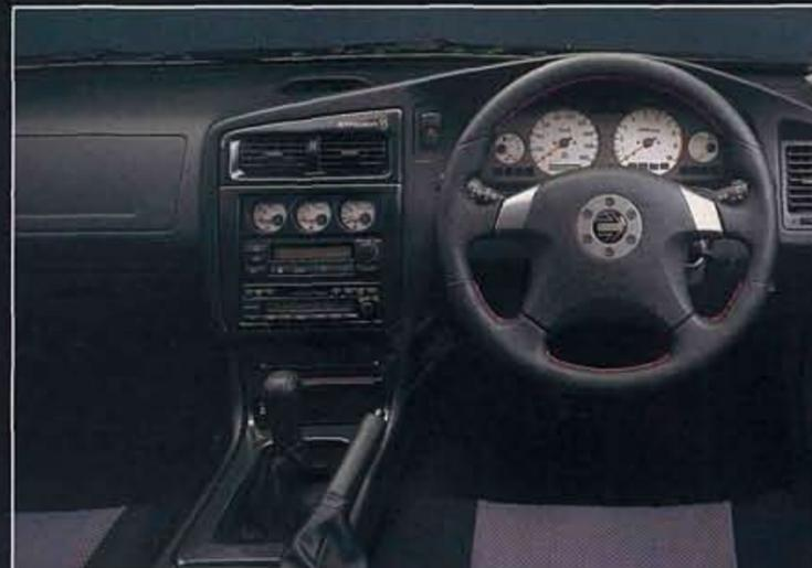
■インテリア 官能領域を堪能できる指定席として、その気にさせる専用装備をあしらった。SRSエアバッグ付の専用MOMOスポーツステアリングホイールは握りやすくしっくりと手になじみ、正確なステアリングワークに貢献している。コンビメーターはスポーツマインドをかきたてる10,000rpmスケール専用タコメーターに変更。またセンターコンソールには、車両の状況を的確に把握できるようフロントトルク計、油圧計、ターボブースト計からなる小径3連メーターを配した。さらにシートは、サポート性を第一に考え、腰・肩をしっかりとサポートする深いバケット形状のスポーツシートを採用。シートメイン部及びドアトリム部にスポーティな際立つキルティングパターンの専用生地を採用した。
