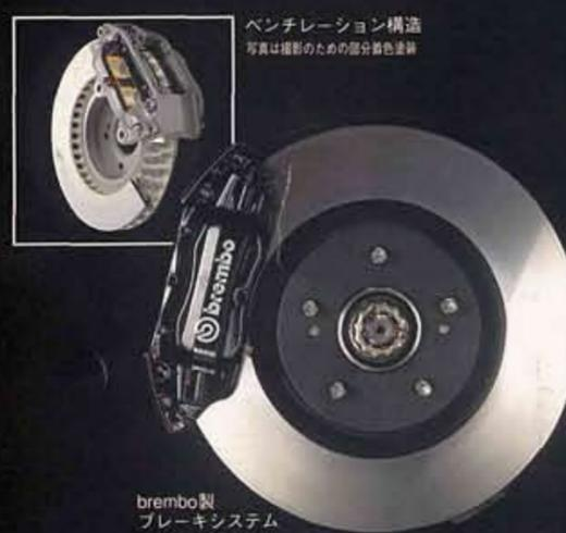
■brembo製ブレーキ 280馬力を安心して操ることのできる確実なブレーキ。そのために名門brembo社製ブレーキシステムを採用した。大径ブレーキローター(フロントφ324×30mm厚/リヤφ300×22mm厚)のベンチレーション部に採用されたダイヤモンドリブ形状が、熱強度、応力分布にすぐれるとともに、従来の一般的な放射状矩形リブにくらべて格段に大きな表面積を実現しているため、ハイカーボン材の採用と相まって極めて高い放熱効果を発揮し、過酷な連続ブレーキングにも十分な耐フェード性を確保。高剛性キャリパーとともに、高速度でも安定した制動力とペダルフィーリングを提供する。
