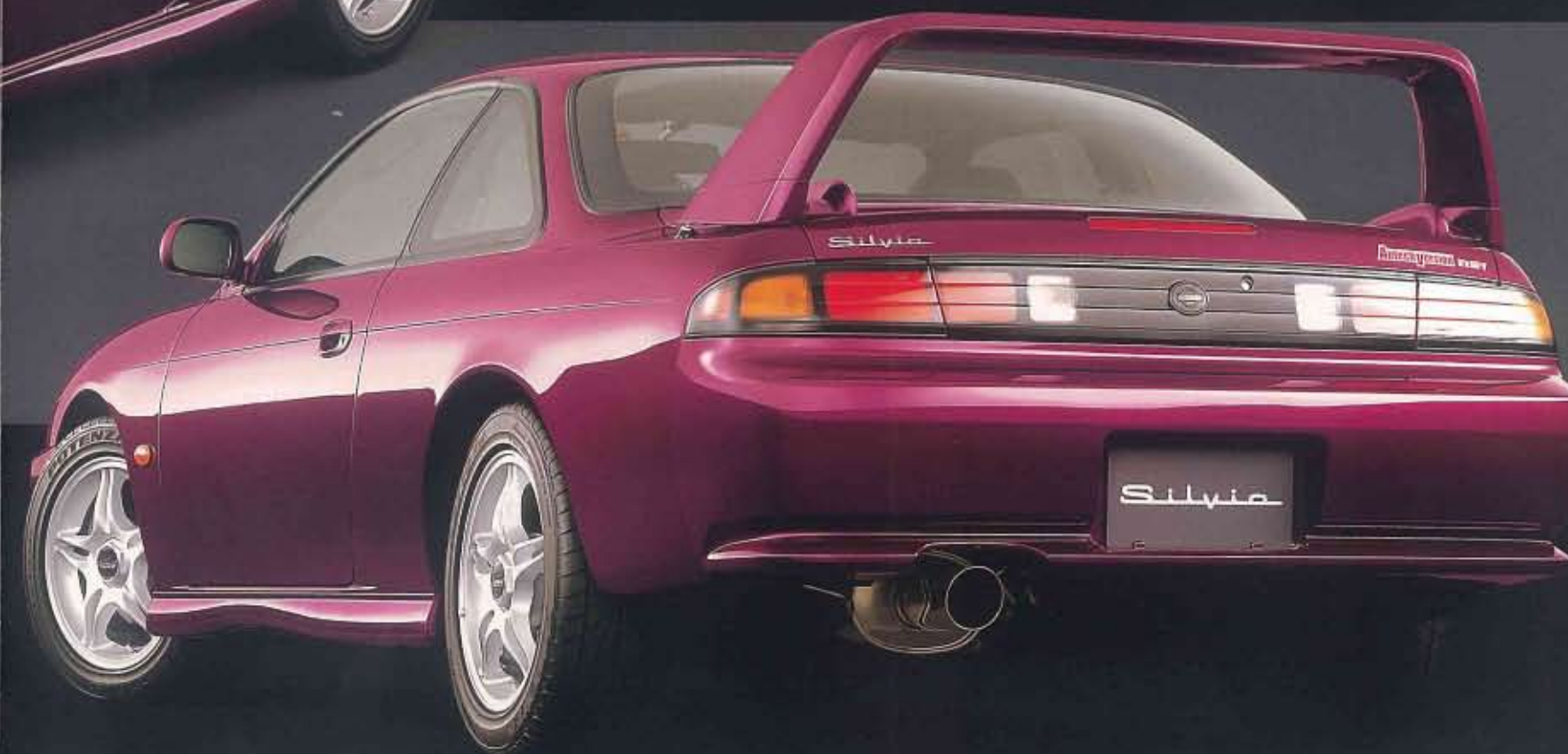
■215/50R16 90Vタイヤ（ブリヂストン製）+16×7JJ専用アルミロードホイール
