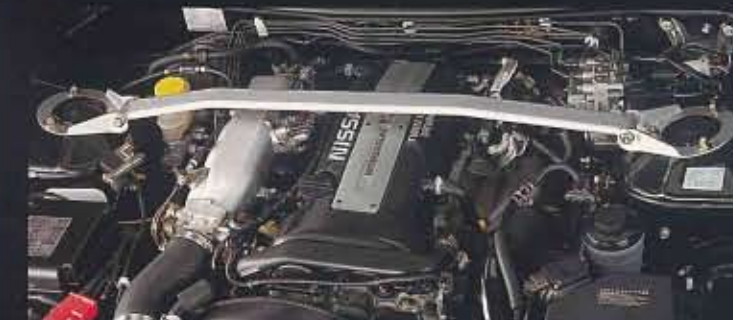
■SR20DETチューンドエンジン+専用フロントストラットタワーバー
