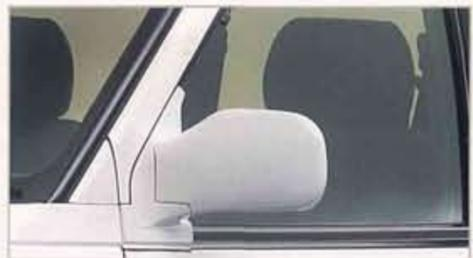
●電動左右独立格納式リモコンアミラー (車体色)
