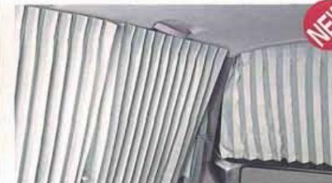
●リニアモーター式電動ビュアクリンカーテン
