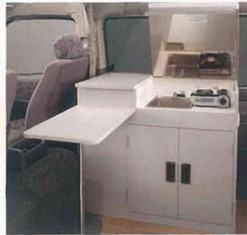
**ギャレー（シンク、給・排水各20リットルタンク、カセットコンロ）**
