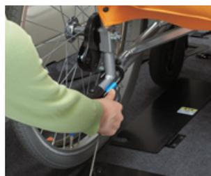
後側フックを掛けて固定装置スイッチの「固定」を押して車いすを固定します。
