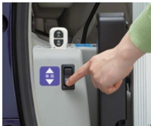
車高調整スイッチを押して車高を下げます。
