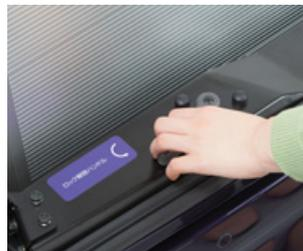
ロック解除レバーを操作してスロープを引き出します。
