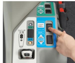
ベルト引出しスイッチを押してウインチベルトを取り出します。
