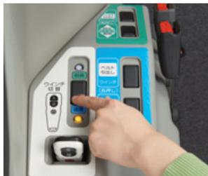
ウインチ切替えスイッチで「前席」と「後席」を切替えます。
