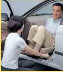
乗車する方がシートにしっかりと座ったら、ここを確認したら、回転レバーを操作してゆっくりシートを回転させます。
