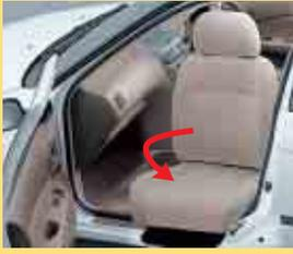
回転用レバーの操作だけで、助手席を横向きに90°回転することができます。カチッと音がしてロックしたら乗り込み準備完了です。
