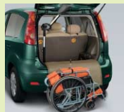
車いすを収納装置に取付けた状態
