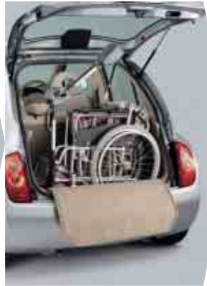
車いすを縦置きに収納した状態(2WDのみ)
