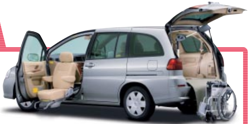
Photo: アンシャンテ 助手席スライドアップシート Gナビパッケージ(2WD)。ボディカラーはダイヤモンドシルバー(M)〈#KY0〉。内装色はベージュ(C)。車いす収納装置はオーテック扱いディーラーオプション。自換式車いすは参考例。
