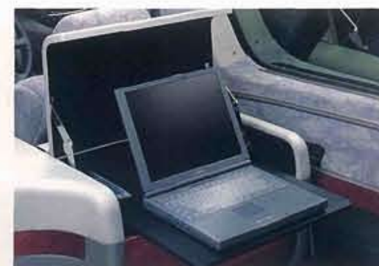
パソコン収納スペース&電源/スライド式テーブル
