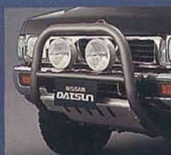
フロントガードバー&フォグランプ (IPF製・スーパーラリー) & フロントアンダーガード
