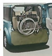
車いすを吊り上げた状態
